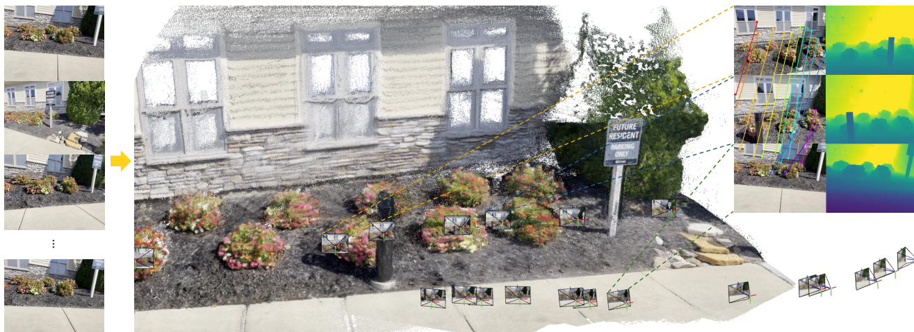
图 1. VGGT 是一个仅含少量三维归纳偏置的大型前馈 Transformer，使用海量带三维标注的数据训练。它可接收多达数百张图像，并在不到一秒内同时预测所有图像的相机参数、点图、深度图和点轨迹；无需进一步处理，其性能通常已优于基于优化的替代方法。
